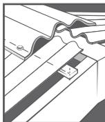
Con la lámina **Tizacril 5** podemos obtener cumbres de dos o tres ondas fijando a los apoyos de la lámina.
